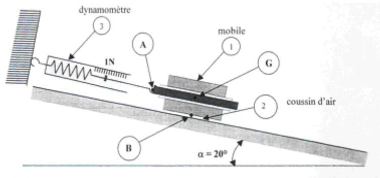
La table à coussin d'air est inclinée d'un angle  $\alpha = 20^\circ$  et le dynamomètre indique 1 N. Dans cette partie, on étudie l'équilibre du mobile afin de déterminer sa masse.
